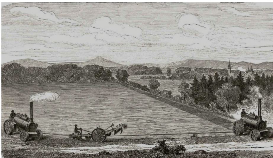
Afbeelding 7: Diepploegen met behulp van twee locomotieven waartussen een kabel is gespannen om een ploegschaar voor de heenweg aan te trekken, en een voor de terugweg 26 .
